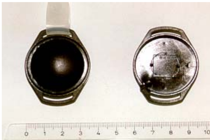
Abb. 1: Exposimeter; links komplettes System für die personenbezogene Messung; rechts geöffnete Diffusionskammer mit innenliegendem CR-39 Detektor
